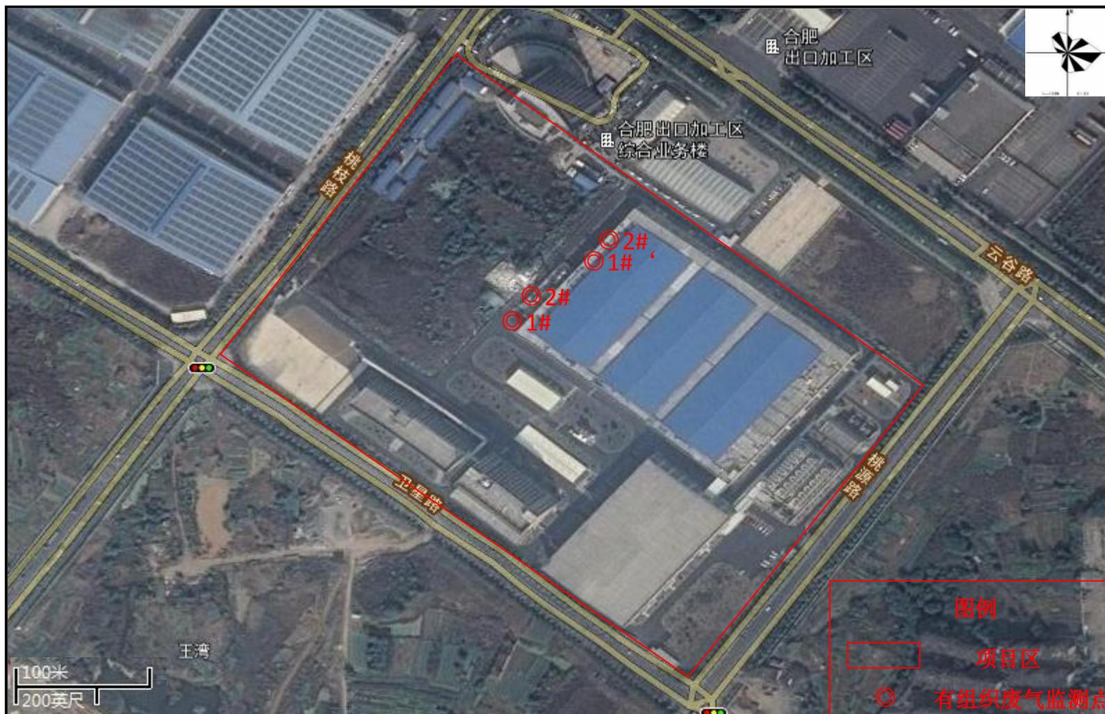
附图 3-3: 无组织废气监测点位示意图
